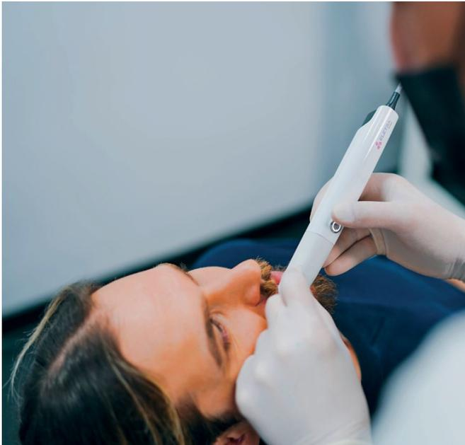
Unser „**kodiertes strukturiertes Licht**“ hat die bemerkenswerte Fähigkeit, 3D-Daten mit nur 1 oder 2 Bildern zu erfassen! Im Gegensatz dazu arbeiten viele andere Scanner mit „sequenziellem strukturiertem Licht“ und benötigen 5 bis 10 oder mehr Bilder, um vollständige 3D-Daten zu erzeugen.
